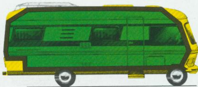
Sicherheit – Fahrgastraum im Hyermobil, vorn und hinten Knautschzonen.
